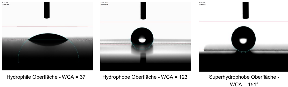
Abbildung 3: Beispiele unterschiedlicher Kontaktwinkel. Links: hydrophile Oberfläche; Mitte: Hydrophobe Oberfläche; Rechts: Superhydrophobe Oberfläche
