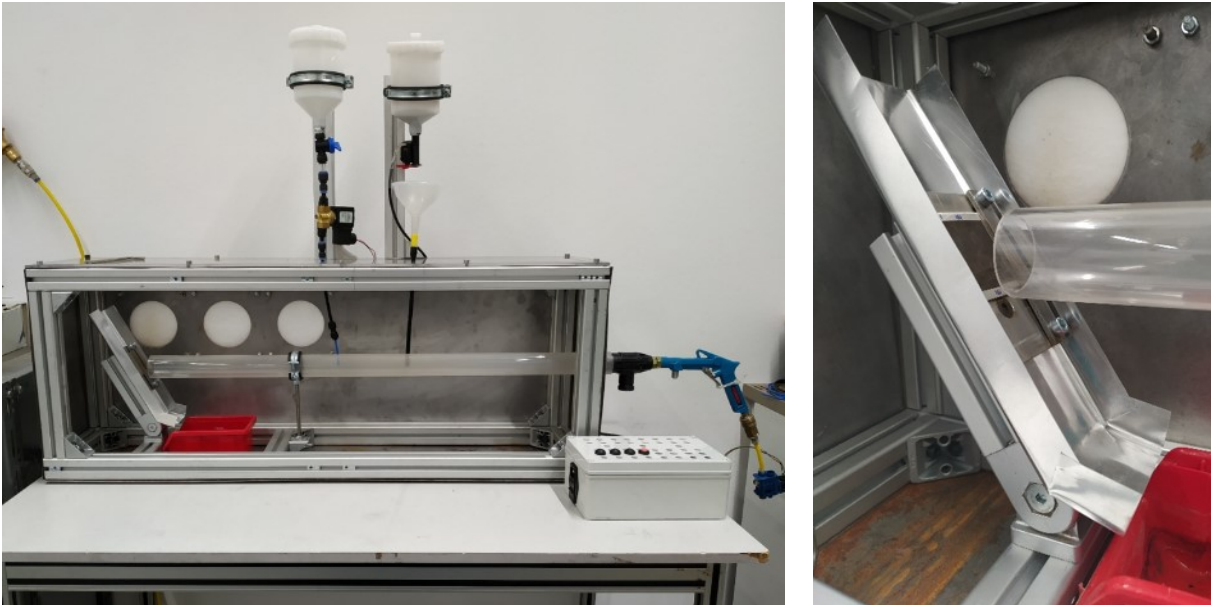
Abbildung 7: Prüfstand zur Messung der abrasiven Verschleißbeständigkeit technischer Oberflächen
